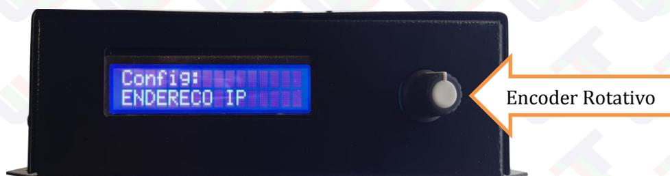
A primeira opção do menu é **ENDERECO IP**, caso você gire o botão do encoder para sua direita, vai ser mostrado as outras opções como: **QTDE PIXEL S1, QTDE PIXEL S2, QTDE PIXEL S3, QTDE PIXEL S4, MODELO LED, SEQUENCIA RGB** e por ultimo a opção **SAIR**.
